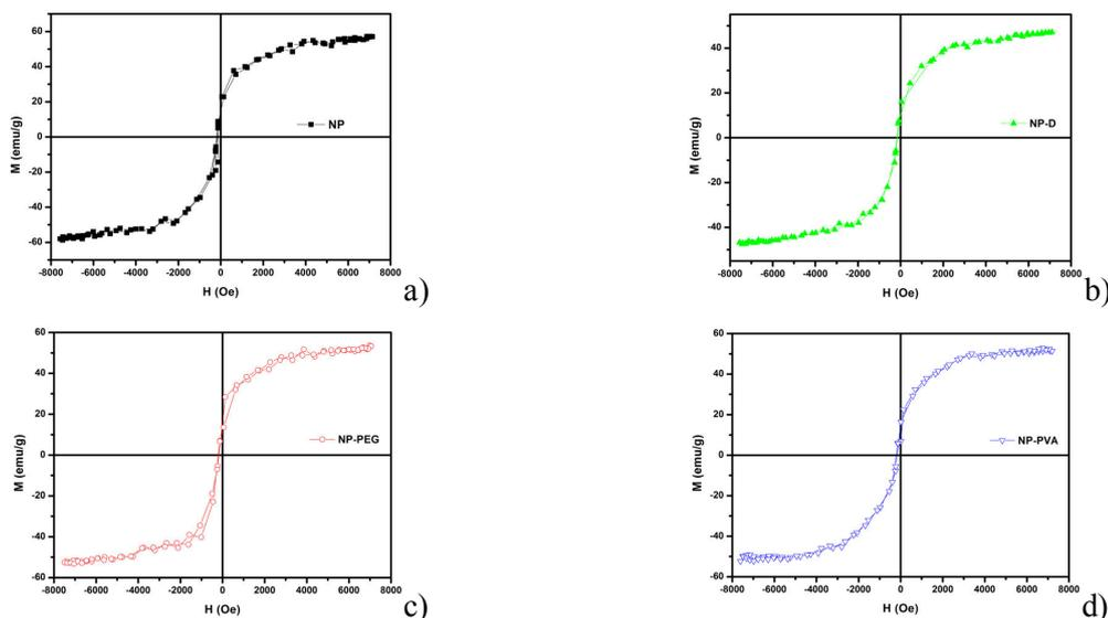
Fig. 4.2. Hysteresis curves of magnetite nanoparticles: a) NP; b) NP-D; c) NP-PEG și d) NP-PVA.
