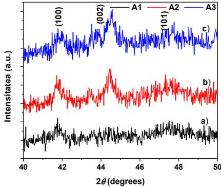
Figure 3.1: XRD patterns (enlargement for the region of Co lines) for the films: a) A1, b) A2 și c) A3 [1]
